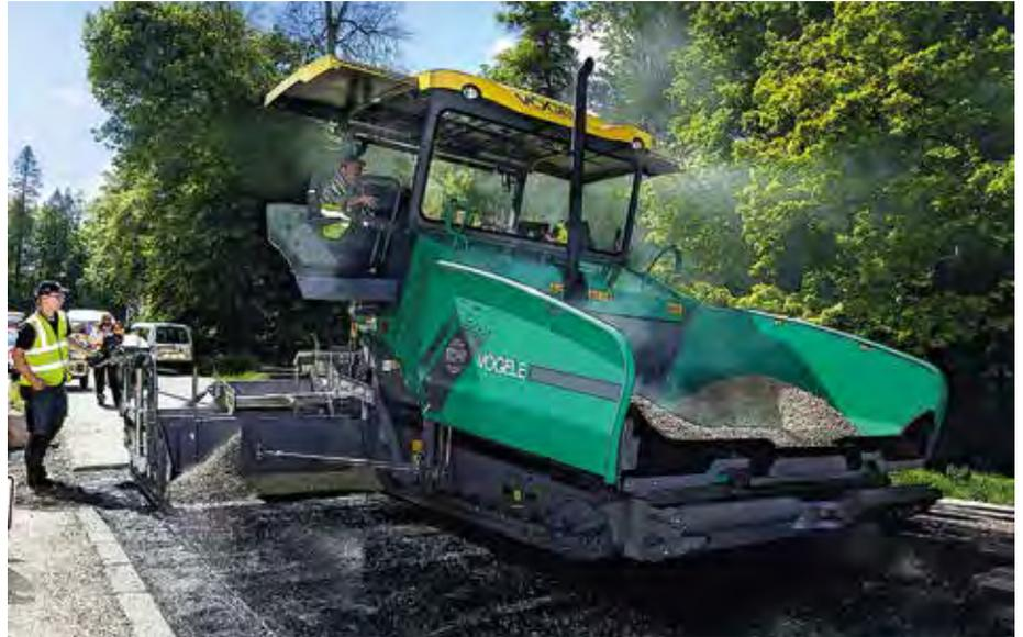
**Kurz, kompakt und dennoch bis zu 7,50 m maximale Einbaubreite:** Der neue Vögele-Straßenfertiger Super 1600-3i ist ein leistungsstarkes Multitalent. (Fotos: Vögele)
