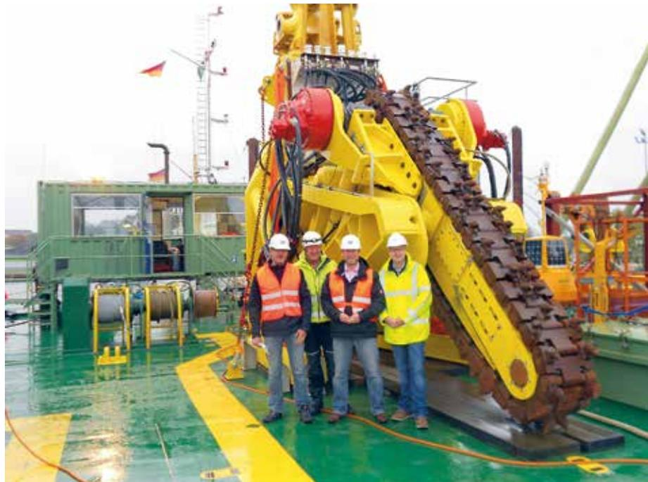
*Auf dem Kabelleger „BoDo Installer“ soll das Hydraulikaggregat eine Unterwasserfräse antreiben, gerade erfolgt der Test der HPU. (Fotos: Zeppelin)*
