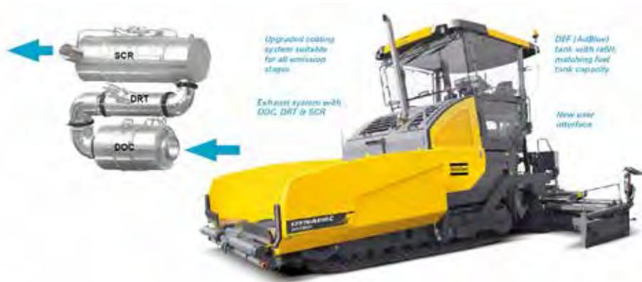
Die mit Tier 4 final Motoren ausgerüsteten großen Kettenfertiger von Atlas Copco tragen zu Kraftstoffeinsparungen bei. (Bild: Atlas Copco)
