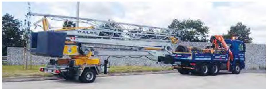
Der Blitzlift Typ 16-20 D mit einer Ausladung von 23 m und einer maximalen Traglast von 1.500 kg ist dank Schnellläuferachsen flott beim Kunden und dort in kurzer Zeit aufgebaut. (Foto: Giebels + Strack)
