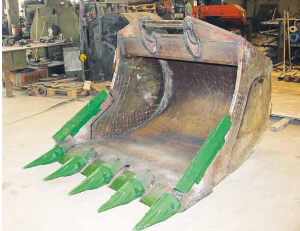
Von HS-Schoch regenerierter Felstieflöffel mit längeren Seitenschnitten aus Hardox 450, Messer aus Borox HB 400, Esco-Schutzschilden an Schneidkante und Lippe sowie Ultralok-Zähnen U55P von Esco. (Foto: HS-Schoch)
