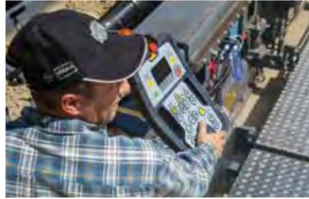
Jede Einbaubreite perfekt im Griff: exaktes Verstellen der Bohlenbreite mit dem SmartWheel.
