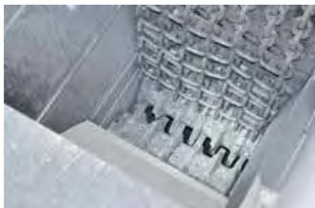
**Das Material** wird zwischen gegenläufig angetriebenen Walzen gebrochen. Ein leistungsfähiges Hydrauliksystem zur Spaltverstellung garantiert, dass unterschiedliche Korngrößen erzielt werden können.
