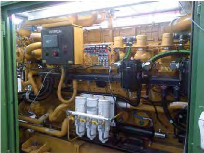
Ein Cat-Schiffsdieselmotor 3516 mit 16 Zylindern und 1.717 kW Leistung treibt die HPU an.
