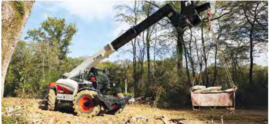
Der 12-m-Teleskop T36120SL erreicht eine Hubkraft von 3,6 t und bietet eine Reichweite von 8,20 m. (Foto: Bobcat)
