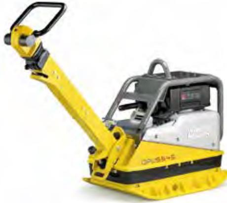
**Wacker Neuson konnte die Hand-Arm-Vibrationen auf einen Wert senken, der ein Arbeiten ohne zeitliche Begrenzung erlaubt. Die dieselbetriebenen Vibrationsplatten DPU 4545, DPU 5545 (Foto) und DPU 6555 erreichen Werte von unter  $1,5 \text{ m/s}^2$ ; die Vibrationsplatte DPU 4045 liegt bei  $0,9 \text{ m/s}^2$ . (Foto: Wacker Neuson)**
