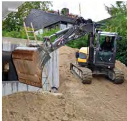
**Durch den serienmäßigen Seitenversatz im Verstellausleger** kann der agile 8MCR um bis zu 2,03 m aus der Maschinenachse nach rechts versetzt baggern.
