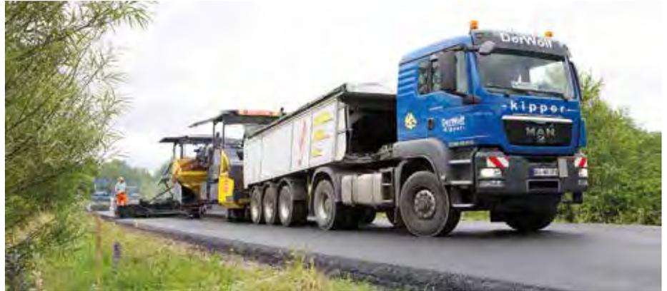
**Die Asphalttemperatur** ist entscheidend für die Asphaltqualität. Der Asphaltprofi-Thermo sichert die Temperaturstabilität während des Transports. (Foto: Fliegl Bau- und Kommunaltechnik)
