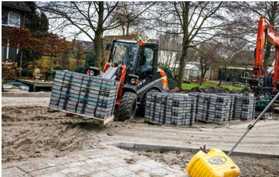
Einsatz mit Gabel: der kompakte Radlader hebt bis zu 2 t. (Fotos: Kiesel)
