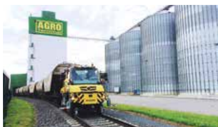
Unimog 2-Wege: Wirtschaftliches Rangieren von Anhängelasten bis zu 1000 t bei vergleichsweise leichtem Fahrzeuggewicht. (Foto: Mercedes-Benz)
