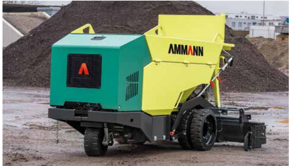
Der neue Minifertiger AFW150-2 mit engem Wendekreis eignet sich perfekt für Gehwege und Ausbesserungsarbeiten. (Foto: Ammann)
