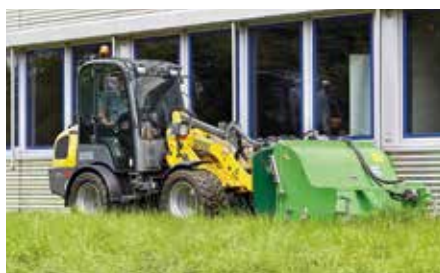
Eine zuschaltbare 100-Prozent-Differenzialsperre verleiht dem Radlader auch auf schwierigem Untergrund maximale Traktion und hohe Schubkräfte bei geringer Bodenbelastung (Foto: Wacker Neuson)
