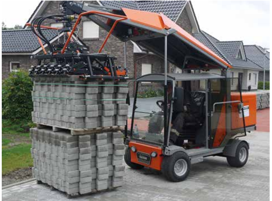
Mit der neuen H 99 Pflasterverlegemaschine ist durch den leistungsstärkeren Motor und eine stärkere Hydraulik ein zügigeres Arbeiten möglich. (Foto: Optimas)
