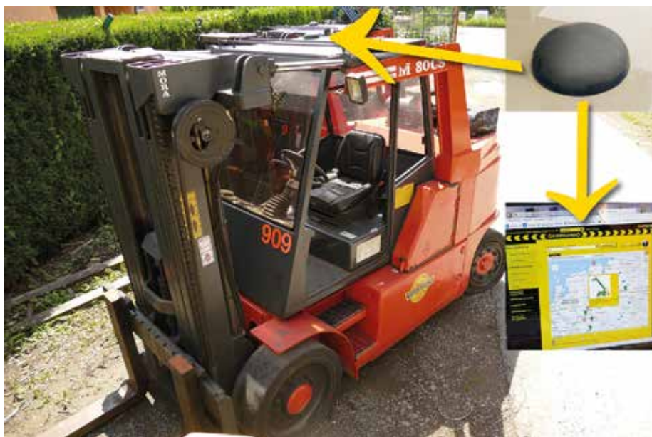
Durch diesen kleinen runden Kasten lassen sich Maschinen orten und sichern sowie Daten übertragen. (Foto: Rösler Software-Technik)
