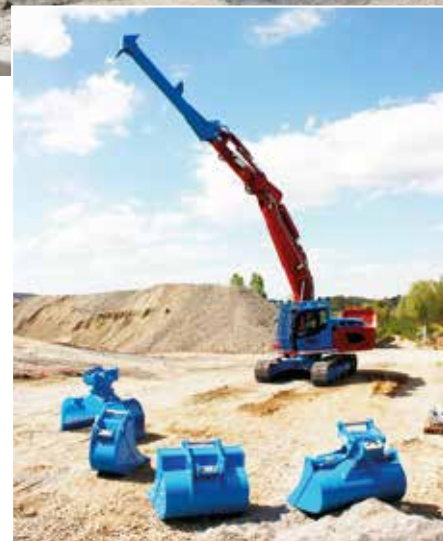
Vielseitigkeit: Der R 924 ist mit zahlreichen Werkzeugen ausgestattet, darunter eines für Abbrucharbeiten.
